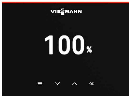
Das 3,5 Zoll große Black Panel Display im Bedienteil zeigt den aktuellen Ladezustand der Batterie an. Der Lightguide informiert auf einen Blick über den ordnungsgemäßen Betrieb des Gerätes.
